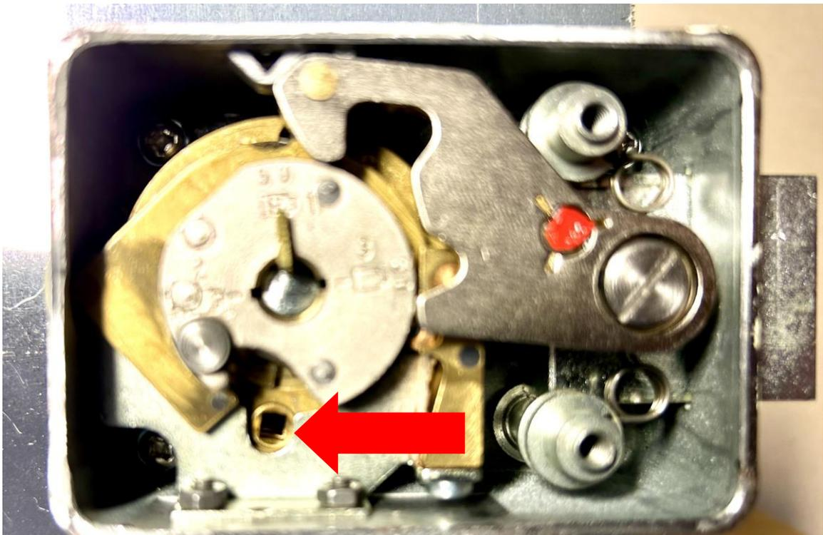
5. Den Schlosdeckel aufsetzen und überprüfen, ob sich der Umstellschlüssel bis zum Anschlag einstecken lässt. Ggf. Position der Scheiben minimal verstellen.
