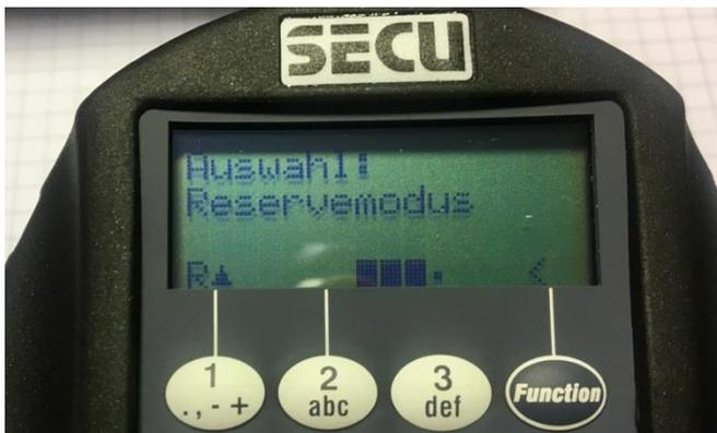
So lange die Anzeige blinkt, kann mit der Taste « 1 » und der Taste « 2 » zwischen dem Reservemodus und dem Standardmodus gewechselt werden.
