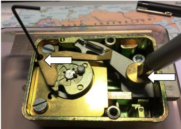
Anmerkung : Bei einigen Modellen ist der Schließhebel nicht verschraubt, sondern nur aufgesteckt. Er lässt sich nach Lösen der Verschraubung der Wippe nach oben ziehen.
